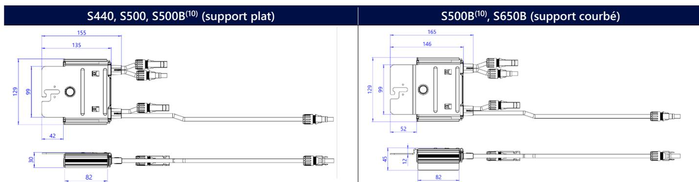
(10) Le S500B est équipé d'un support plat ou d'un support courbé. Le S500B-1GM4M<sup>RM</sup> a un support plat et le S500B-1GM4M<sup>BM</sup> un support courbé.
