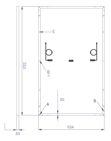
A: Drenaggio; B: Ventilazione; C: Buchi per il montaggio; D: Messa a terra
