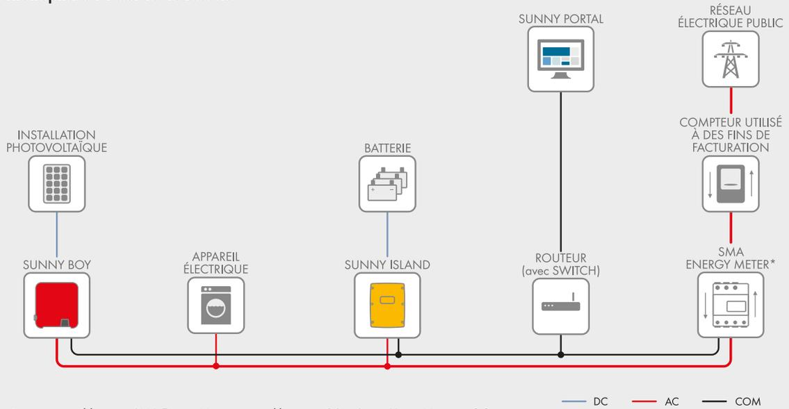
D'autres fonctions sont possibles avec SMA Energy Meter powered by ennexOS et Sunny Home Manager 2.0.
