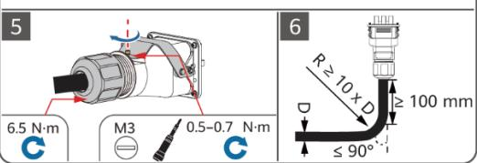
**BG** Свързване на AC изходящ захранващ кабел
