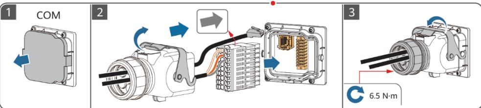
**BG** Свързване на сигнални кабели
