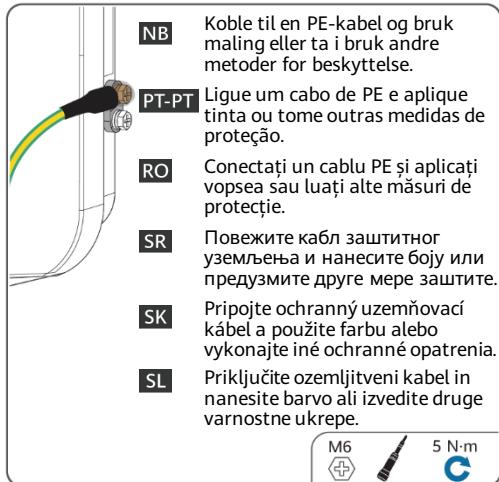
**NB** Koble til en PE-kabel og bruk maling eller ta i bruk andre metoder for beskyttelse.
