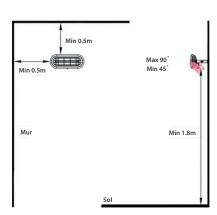
Montage au plafond (hauteur de montage recommandée : 1.8 - 2.4 M)
